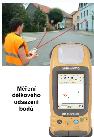
Měření v lokalitách doposud pro samostatnou GPS technologii nedostupných
